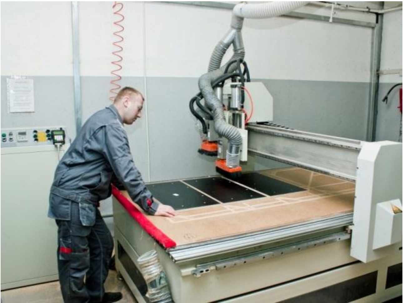
Автоматический станок с ЧПУ, по раскрою и присадке деталей подставок из ЛДСП
