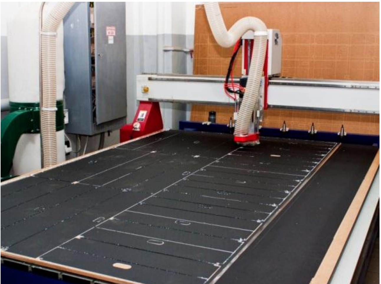
Автоматический станок с ЧПУ, по раскрою пластиковых деталей (верхние крышки)
