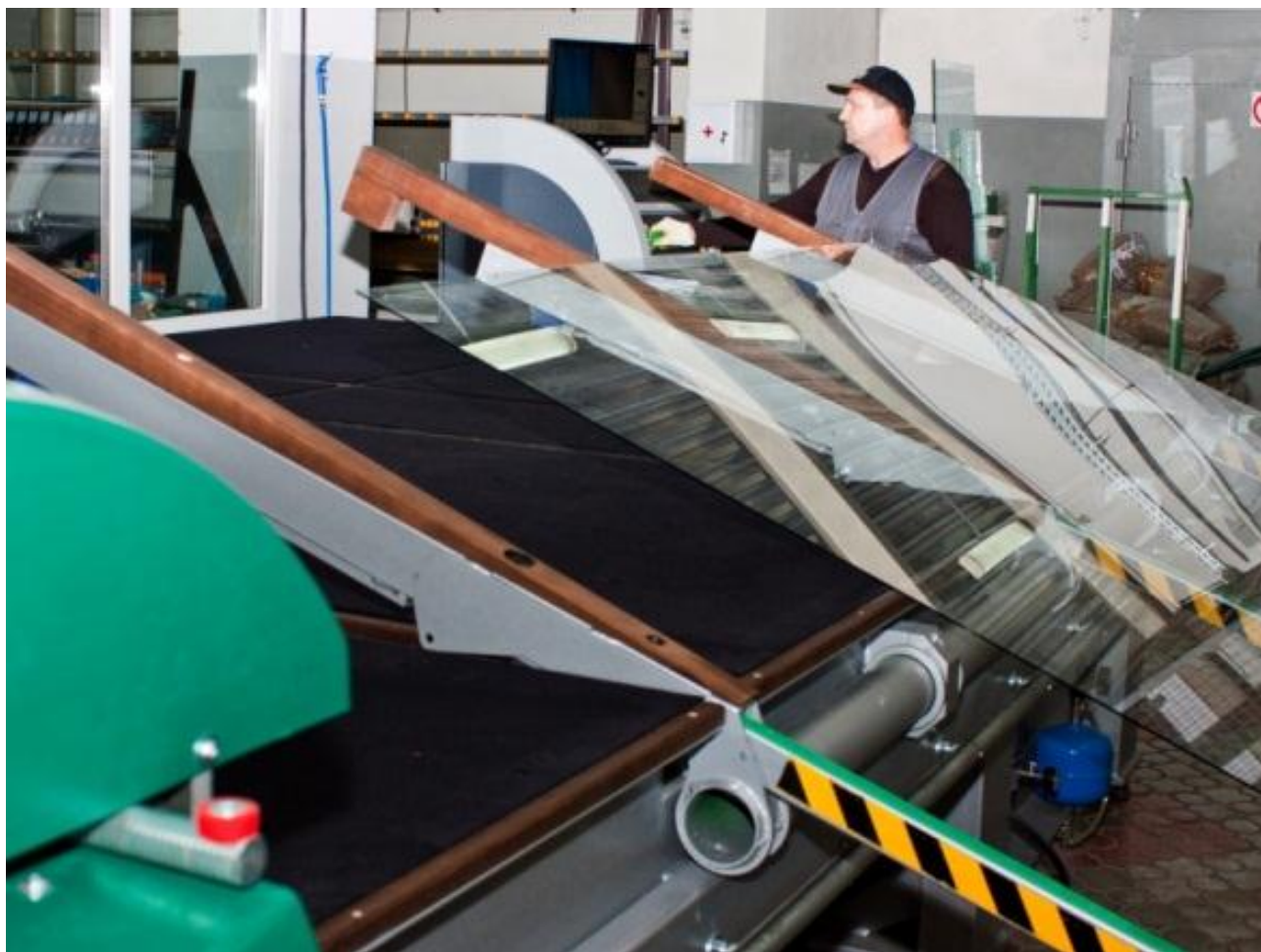
Автоматическая загрузка стекла на раскроечный стол
