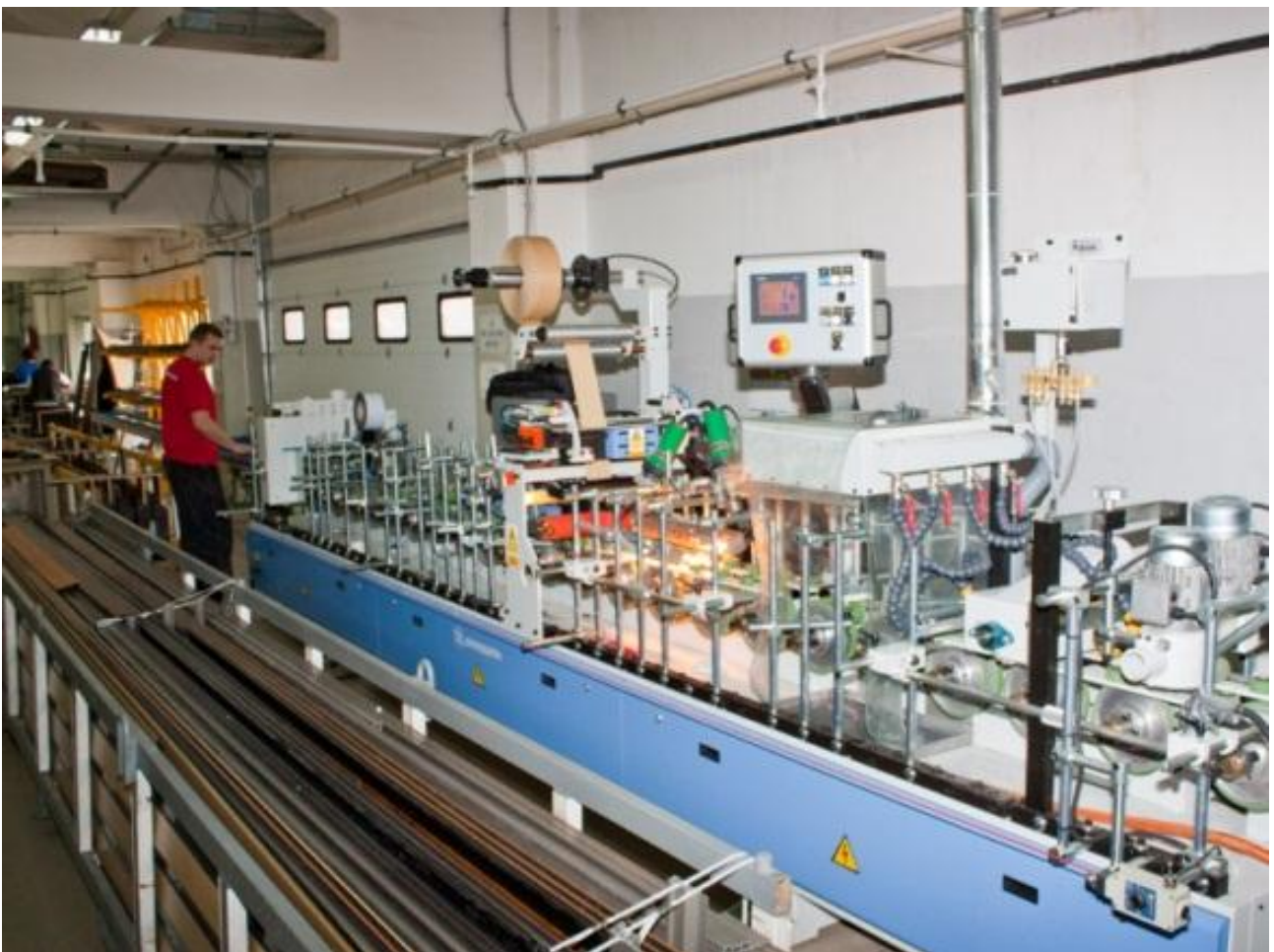
Окутывающая линия с ЧПУ, по ламинированию пластиковых деталей цветным покрытием
