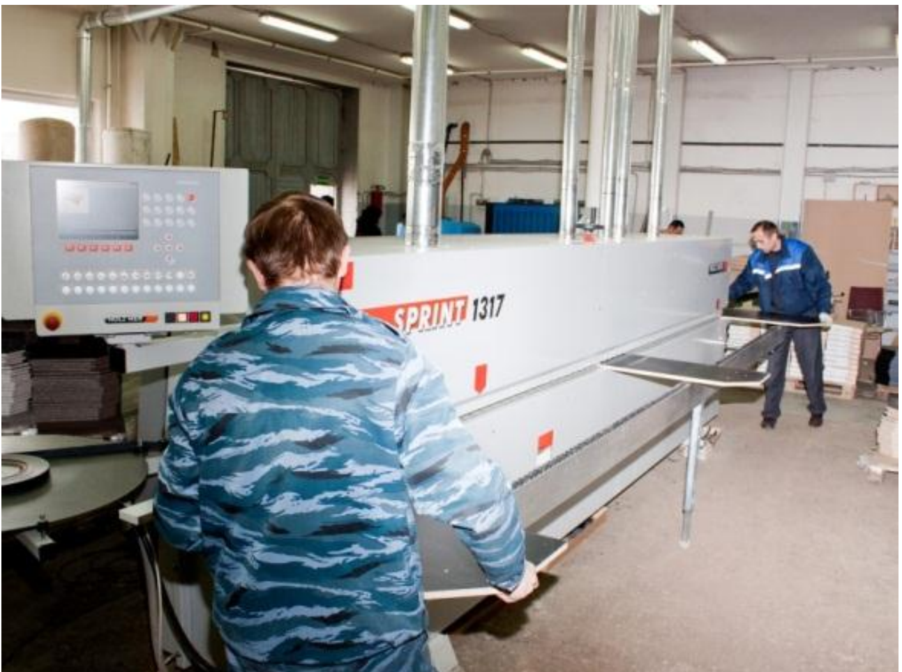
Автоматическая линия с ЧПУ, по нанесению кромки, с функцией фрезеровки углов "ROUND"
