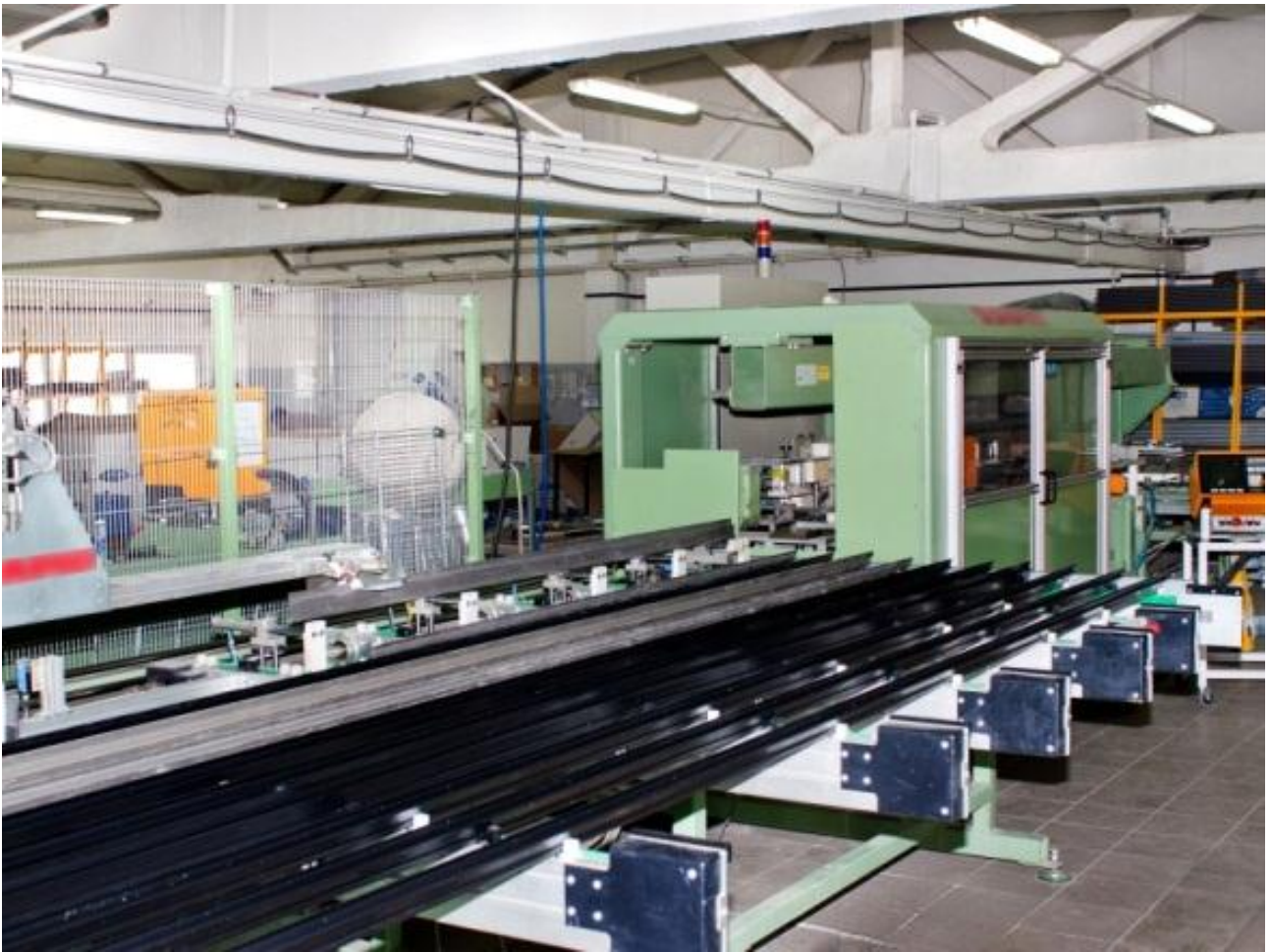
Обработывающий робот по резке и фрезеровке деталей, с оптимизацией края и автоматическим удалением отходов
