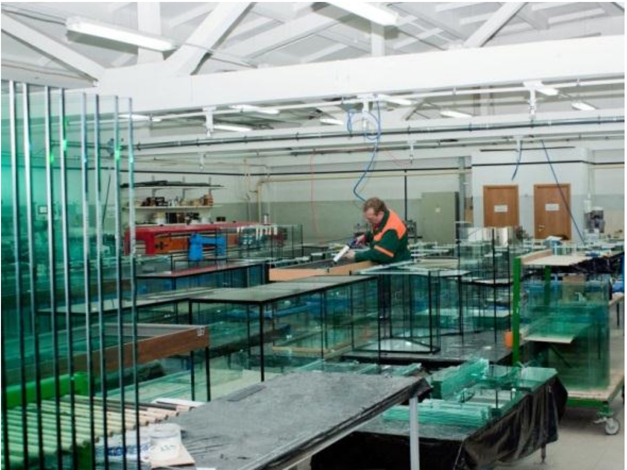
Цех сборки аквариумов, с пневматической подачей герметика
